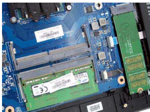
暗影精灵2内部接口属于现有高性能游戏本的标配级水准,M.2、双内存插槽一应俱全,短时间内不会过时
