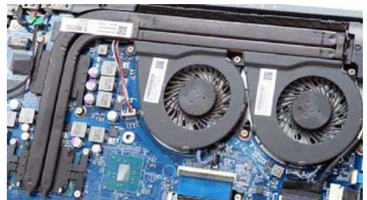
处理器和显卡使用同样的两条热管进行散热也就意味着效率的降低,但这也是为了轻薄化设计不得不做的妥协,结果就是无法在考机测试中始终保持高睿频
