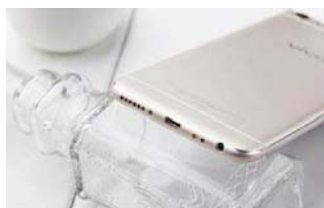
耳机孔、接口和扬声器都集中在底部,顶部不再有任何开孔,但这些开孔有些轻微刮手感
