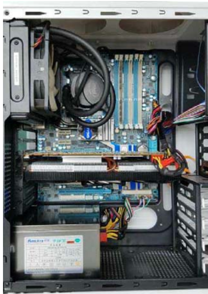
模组化电源可以选择最少的供电线材,保证机箱内散热风道通畅
