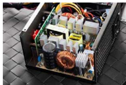
双管正激的架构,齐备的EMI电路保证了电源的输出品质
