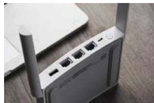
机身最右侧的WPS按钮能够让设备在不输入密码的情况下快速连接无线网络
