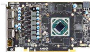
RX 480 PCB长度只有18cm左右, 非常小巧。显卡采用了6相供电设计以及三星的GDDR5显存
