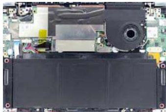
该机采用掀底盖维护的方案,但即便是拧下螺丝后也需要一番力气才能打开紧密贴合的底盖。就内部设计来说S5-371与大多轻薄本一样非常紧凑,而且布局很规范
