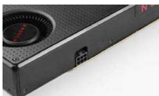
得益于新架构和新工艺, RX 480的功耗很低, 仅用一个6pin接口即可满足供电需求
