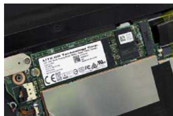
SSD是S5-371之中除了无线网卡之外唯一可以更换的部件,也就是说该机的内存也采用了固化设计,这就让搭载4GB内存的低配版显得有些尴尬了
