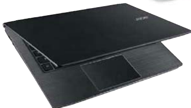
S5-371的体型较为小巧,铝合金C壳和镁合金机身设计让它的耐用性也达到了较高水准
