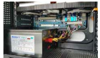
仅需两组模组线,即可完成安装,机箱内更加简洁
