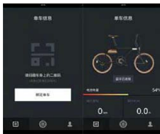
扫描电源盒内的车架号二维码进行绑定,然后通过蓝牙连接,便可查看一些自行车的相关数据和电量等状态
