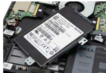
2.5 英寸 SSD 是 Sandisk 的 Z400 系列,属于“商用级 SSD”。如果你看它不惯,直接换一个 256GB 的吧,代价小,选择面也很大
