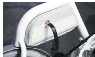
电池盒需要钥匙才能打开,内部是1公斤重的锂电池
