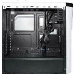
机箱采用了上下分层散热设计
