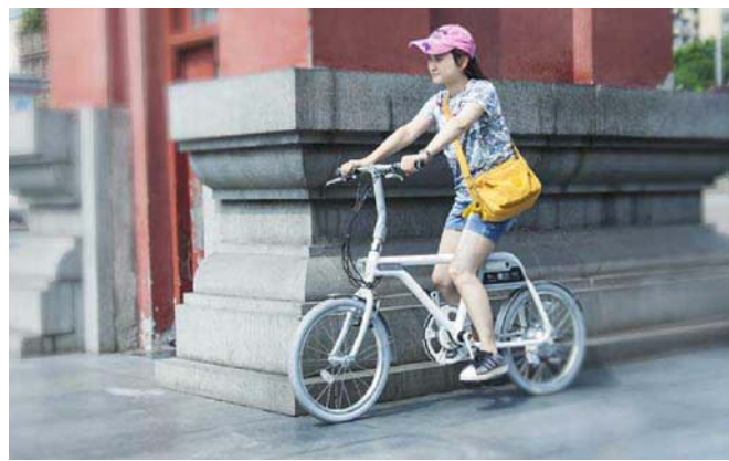
轻客TS01在起步的时候,电动助力介入比较突兀,只轻轻地蹬一下踏板,就会迅速加速,有种“向前踹”的趋势
