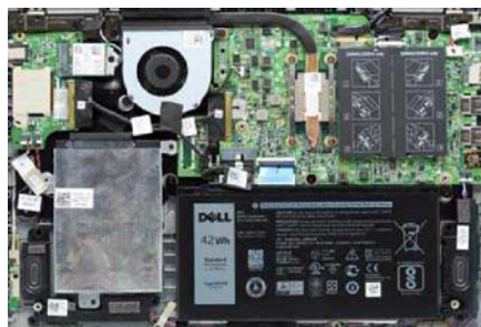
该机的可维护性很强,拧下 8 颗底部螺丝就能轻松撬开底盖进行维护,电池是 42Wh,2.5 英寸 SSD 便于更换
