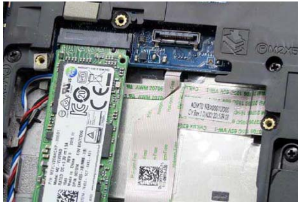
我们测试的版本搭载了 M.2 SSD, 但因为布局的关系, SSD 与 2.5 英寸硬盘位重叠在一起不能同时使用, 而且如果要使用 HDD, 还得通过转接线来连接主板接口
