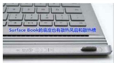
底座和主机部分一样,也是有散热孔的,底座内部有散热组件(给独显散热)
