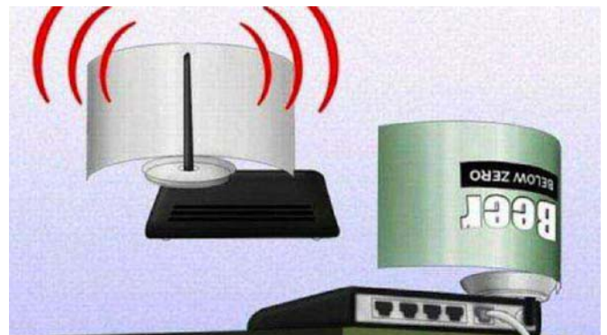
将铝制薄片按照正确方式套在无线路由器天线上
