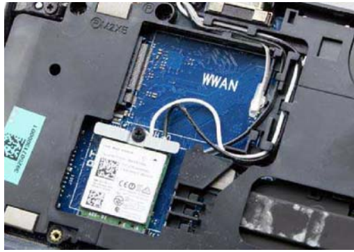
预留 WWAN 接口和天线方便升级 3G/4G 模块。除此之外英特尔 Wireless-AC 8260 无线网卡性能强劲, 天线还用金属片压紧防止磕碰机身时脱落, 很人性化
