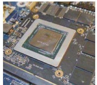
显卡部分为 MXM 接口的 GTX970M, 也就是桌面版 GTX960, 两者规格相同
