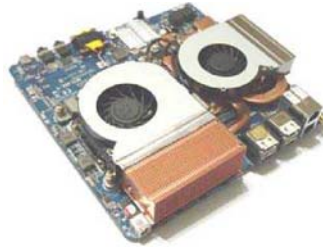
ZBOX-SN970 主板正面及散热设计
