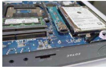
内存、硬盘以及 M.2 扩展槽都集中在背部。图片中的 USB 接口很有意思: 厂商建议你无线手柄的接收器插在电脑内, 这样外部看起来更加整洁
