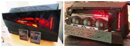
通过高速雷电接口,外置显卡坞就能为笔记本、平板提供顶级桌面显卡的强大游戏性能
