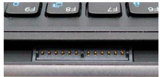
专业键盘底座插槽里面的触点,如果有强力的磁吸引导设计就更好了
