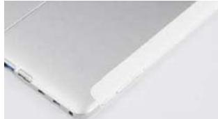
金属和塑料接缝处不够紧密,存在着一定的缝隙
