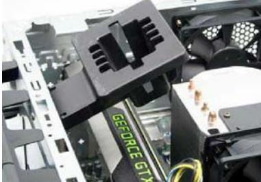
显卡的固定方式很特别,并不是传统的加固支架设计,而是采用了这种通过与侧面板接触的按压式加固。我们在机箱竖置时尝试用手摇动显卡,稳定性还是挺不错的。
