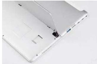
支架开合处裸露在外的金属铰链处理得比较粗糙
