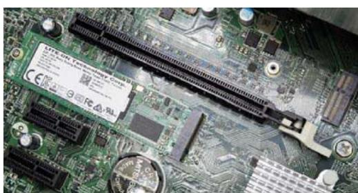
Predator G6 只有一个PCI-E × 16 接口,这也意味着无法升级到双显卡方案,取下显卡后可以看到该机采用了建兴的128GB SSD,虽然是M.2接口,但走的是SATA总线,写入性能相对普通。除此之外该机预留了升级无线模块的M.2接口,但没有预埋天线。
