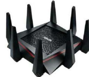
华硕 RT-AC 5300 在双频段无线信号都采用4×4MIMO，所以有8根天线
