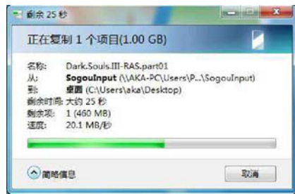
两个 701AV 电力猫在不同房间墙壁插座上的表现
