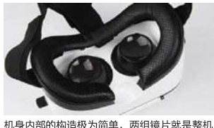
机身内部的构造极为简单,两组镜片就是整机最重要的组件
