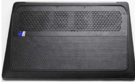
该机的底盖设计很有特色,上方是面积超大的散热进气口窗格,下方是凹凸质感的三角锥设计,非常独特
