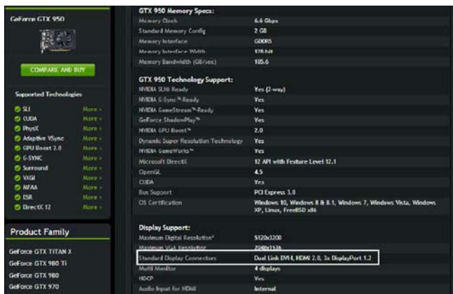
NVIDIA 9系列显卡中,连GTX 950这样的千元级产品都带有HDMI 2.0接口
