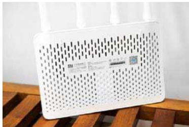
底部分布了密密麻麻的小孔,已解决高负载状态下的散热问题
