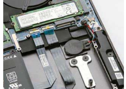
该机预留了第二个 M.2 PCI-E SSD 升级接口,考虑到本身就配备了性能非常强悍的三星 SM951,若是双 SSD 组建 RAID 0,性能无疑将更上一层楼
