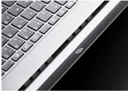
该机的散热出风口设计在屏幕与键盘面之间,缝隙相对较小,但ZBook Studio G3 的硬件配置相当强,这就导致它即便是静置状态,键盘顶部也会有明显的热量堆积,满载时更是手不能碰
