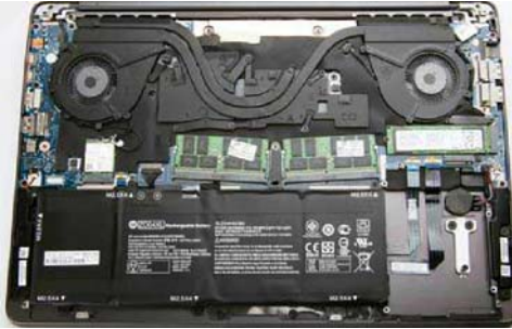
ZBook Studio G3 的维护很方便,而且所有底部螺丝都采用了固定式设计,不会掉落。而该机的内部设计很紧凑,没有什么明显的不足。大哥,内存插槽怎么感觉是歪的? 没错,就是歪的,故意的
