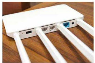
提供了两个LAN口+一个USB接口,以满足最基本的日常使用需要
