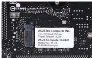
主板的 M.2 插槽设置在底面
