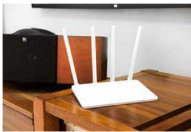
采用了4根外置全向多振子高增益天线,双频性能增强方面有所保障
