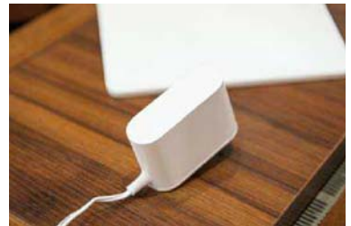
电源适配器尺寸比较大,但依然是12V/1A的规格
