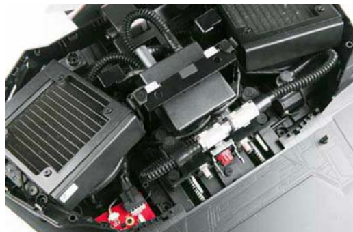
水冷模块的保护盖也可在拧下底部螺丝后打开,配备了 2 个散热风扇、1 个水泵以及 1 个备用水泵,但需要注意的是玩家无法自行添加冷却液,当系统内软件提示需要添加时就得到售后去添加
