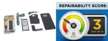
S7 Edge 维修最难的地方在于想在损坏显示屏的情况下更换触控面板几乎是不可能的
