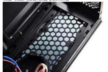
顶盖下方是隐藏的240mm散热排安装位,可打造个性化水冷系统
