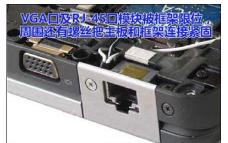
VGA 口及 RJ-45 口模块被框架限位,周围还有螺丝把主板和框架连接紧固
