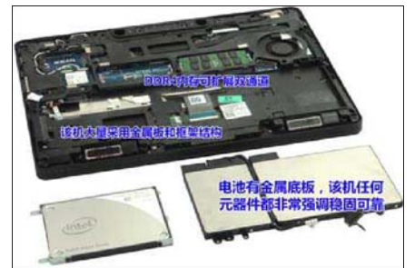
Latitude E5270 掀开盖子就能进行升级维护。该机内部非常规整且采用了框架结构设计。不过要想进行排气槽的维护需要进一步把内部框架拆下来
