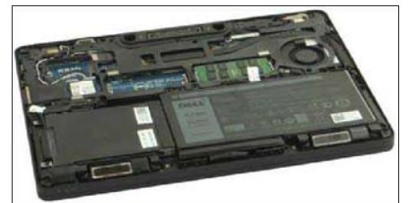
Latitude E5270 掀开盖子就能进行升级维护。该机内部非常规整且采用了框架结构设计。不过要想进行排气槽的维护需要进一步把内部框架拆下来
