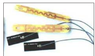
单频2.4GHz(上)与5GHz天线(下)在尺寸和结构上有较大区别
