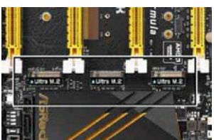
要注意主板上的 M.2 接口是否兼容所购 M.2 SSD 的工作方式
