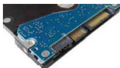
标准的SATA 6Gbps接口, 最高读取速度133MB/s
