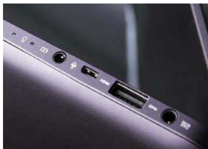
虽然是极致轻薄本，但U305UA的接口其实并没有太多的妥协，3个USB3.0接口足够使用，只是HDMI输出要么需要特别的小口线，要么需要转接，稍麻烦一点
