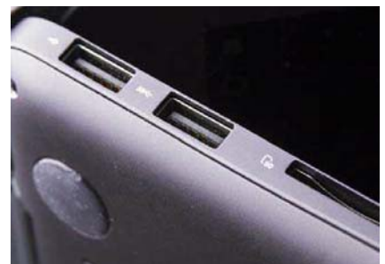
虽然是极致轻薄本，但U305UA的接口其实并没有太多的妥协，3个USB3.0接口足够使用，只是HDMI输出要么需要特别的小口线，要么需要转接，稍麻烦一点
