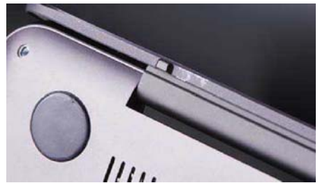
细节设计方面，U305UA在转轴底部预留了一个小小的脚垫，可以在打开屏幕的同时稍稍垫起机身，给散热出口预留空间，这个设计比较聪明
