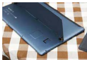
变形支架可以支持两档的变形支撑,便于打字、观看
