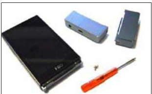
利用X7附送的T5螺丝刀拆下螺丝,更换模块
