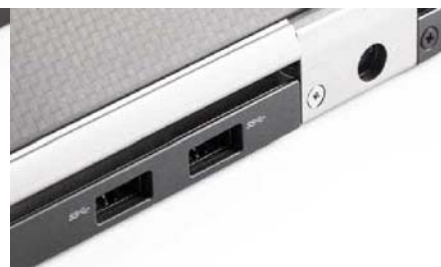
E7470 将大量接口后置,因此它也拥有很多轻薄本没有的丰富接口配置,实用性较强的双视频输出和千兆有线网卡都得以保留
