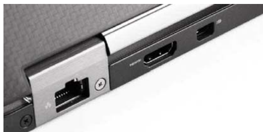
E7470 将大量接口后置,因此它也拥有很多轻薄本没有的丰富接口配置,实用性较强的双视频输出和千兆有线网卡都得以保留
