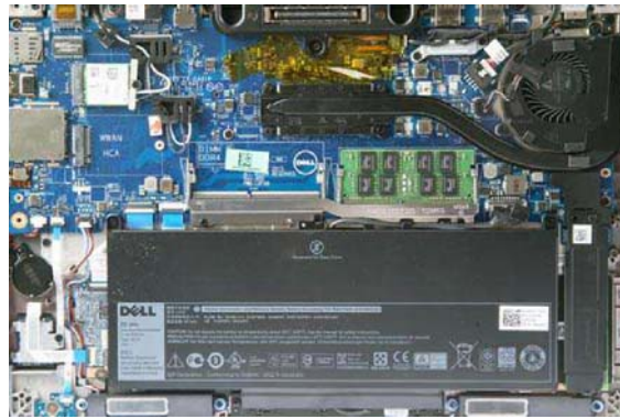
内部设计方面,虽然因为轻薄的关系没有采用框架结构,但四角均有加固筋设计,除此之外还预留了第二内存插槽了 3G/4G 模块升级位(预埋天线和 SIM 卡插槽),实用性较强
