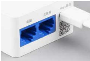
Magic B1无线路由器的接口设置在电源适配器上
