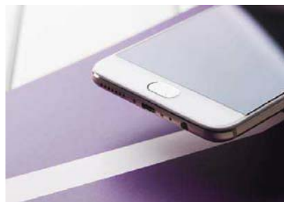
中间的数据接口并没有使用USB-Type C,毕竟OPPO的VOOC闪充技术需要特殊的针脚做适配
