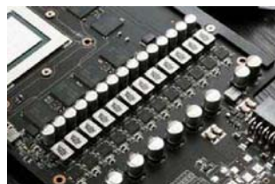
在有信仰的玩家眼中,这不仅仅是高效的 12 相供电,更是傲视一切的气势
