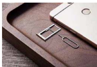
采用了Micro SIM+Nano SIM或Nano SIM+TF的与卡槽设计,机身工艺出色,插入后严丝合缝
