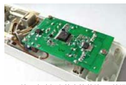
USB接口电路板上的主控芯片,元件焊点饱满
