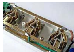
铜条采用一体化成型冲压设计,稳定度高
