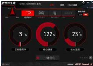
水冷有多强? GTX980Ti 待机 23°C,满载考机不过 49°C
