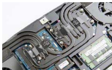
G155P 依然采用双风扇散热系统,热管数量多,但即便如此要 Hold 住桌面 i7 也很麻烦
