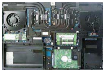
该机底部设计有 2 个盖板,打开后可对内部进行完全维护
