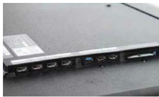
电视接口中,右侧的插槽即CAM卡槽
