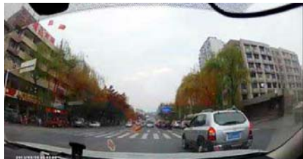
某行车记录仪140度的广角镜头完全可以拍摄到车道及两侧的景象,但边缘畸变明显
