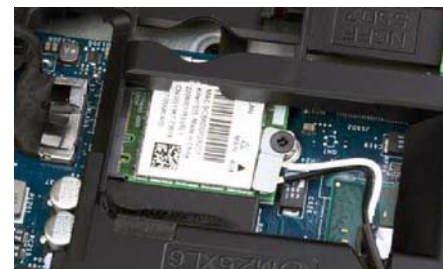
细节设计上,为了避免意外磕碰让无线网卡天线脱落,Alienware 17甚至特别使用了一块小金属片对天线加固,很人性化
