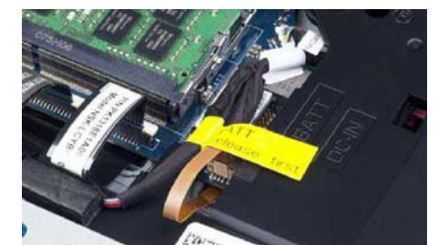
每一个接口和数据线都标注了用途和功能,相当贴心和严谨。电池连接线更是采用更醒目的黄色胶布,提示玩家在维护前先取下电池
