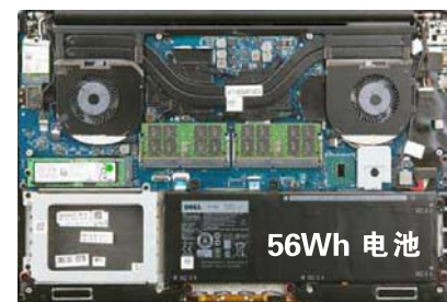
XPS 15 底部使用了六角形螺丝固定,需要特定螺丝刀头才能取下并打开底壳,而该机的内部结构很紧凑,用料上乘,84Wh 锂离子聚合物电池占据了下方位置。不过 56Wh 版(下图)可以升级 HDD
