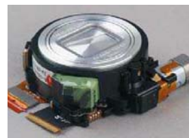
不管是外伸缩式还是内伸缩式,较大的模组高度都难以与手机整机结构和ID设计相协调
