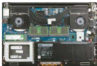
Precision 5510 非常好维护,拧下底部螺丝就能打开底盖,其内部结构紧凑用料扎实,整体布局没有明显问题。我们测试的 56Wh 电池版预留了一个 2.5 英寸硬盘接口,如果是 84Wh 大容量电池版,这个接口的位置就被占据了,只能使用 M.2 SSD
