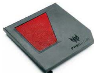
当然,也有宏碁掠夺者G9-791这种在基于双风扇主散热器之余,还能搭配光驱进气风扇的设计
