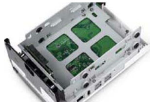
无论是拆开威联通 TAS-268的外壳还是拆下硬盘,都不需要工具
