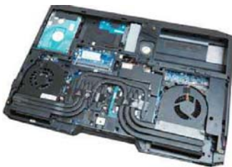
但对于讲求轻薄设计的当下而言,即便是最新采用桌面级GTX 980独显的顶级游戏本,双风扇也基本是唯一的选择
