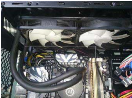
安装完水冷排后,把线材按到风扇后面去
