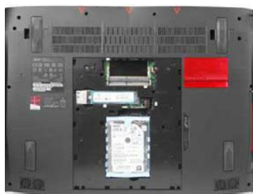
通过拧下2颗螺丝就能取下Predator G9-791的底部小盖板,预留的2个DDR4内存插槽就在这里,除此之外还能对SSD和HDD进行维护
