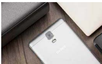
虽然机身并不薄,但摄像头依然有轻微凸起,另外,该机只配备了单色温闪光灯
