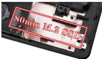
小新700还预留了1个80mm M.2 SSD接口可供升级,同时兼容SATA和PCI-E总线SSD,有条件的玩家应该优先考虑后者
