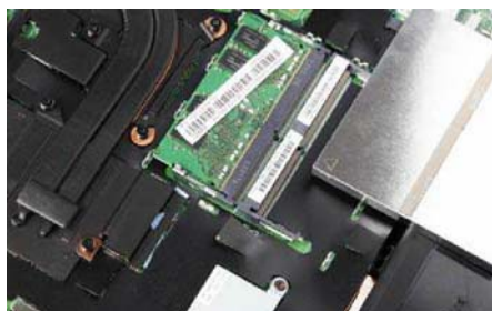
内存插槽采用金属遮盖层设计,保证DDR4内存不受其他配件的电磁干扰,这是近年来笔记本中难得一见的设计,除此之外主板采用黑色绝缘纸覆盖,品质靠谱
