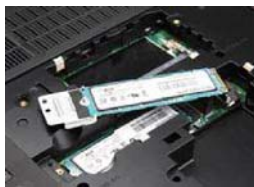
需要注意的是,Predator G9-791采用了双SSD组建RAID 0的方案,我们测试的版本为2×128GB的配置,性能相当给力
