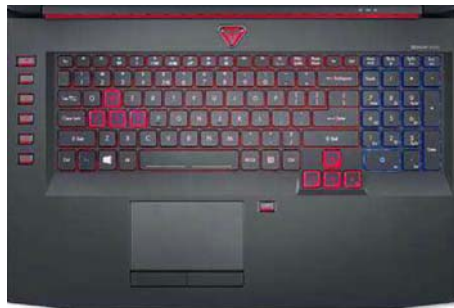
Predator G9-791的键盘采用四区红蓝双色背光设计,左侧还有5个自定义按键,而且可切换为3组不同功能,实用性很强
