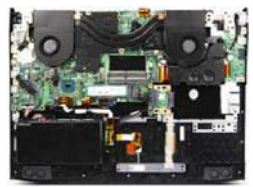
想要对Predator G9-791内部进行清灰,只需继续拧下底部螺丝,并掀开屏幕后方的装饰条就能揭开底盖了,该机的内部做工扎实,采用双风扇散热方案,散热片覆盖面积很大
