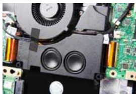
庞大的双低音炮单元,让Predator G9-791的扬声器表现很震撼。不过,该机的扬声器还需要进一步调校
