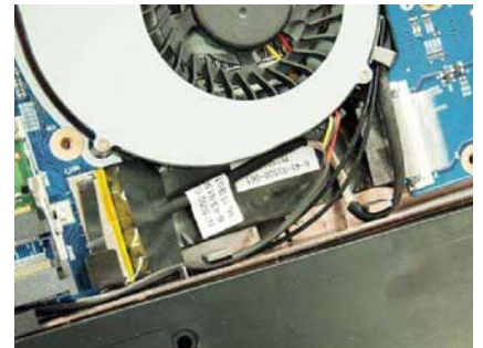
左侧的功能 PCB 虽然也是靠线材与主板连接,但并不是悬在空中容易被“误伤”的飞线,而是紧贴 C 壳走线,这个设计很聪明
