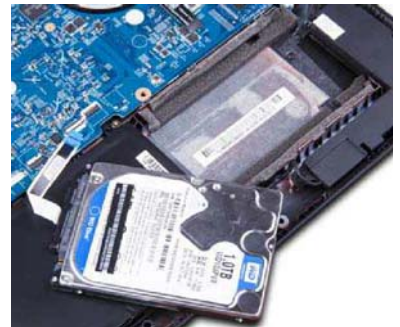
不过该机的 2.5 英寸硬盘位并未使用螺丝，而是用海绵支撑固定，虽然可以降低震动影响，但在几番拆装之后就很难还原了
