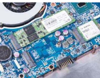
G150T 大圣本预留了 3G 模块升级接口,侧面也有 SIM 卡插槽,只是没有预埋天线
