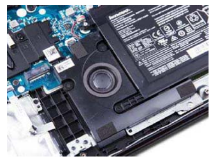
该机采用了本次参测产品中体积最大的扬声器单元,而且是 2.1 声道结构,所以它能在听音表现上夺魁也属情理之中了
