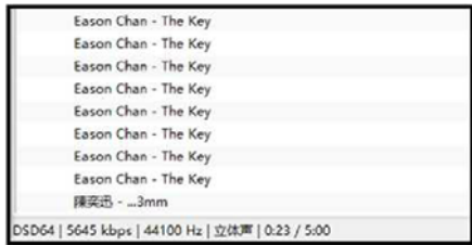
软解的DSD音频码率不变,但采样率已经变了
