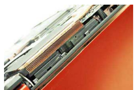
该机的扬声器被挤压在散热器下方靠近 C 面的位置，空间有限，所以功率也大不起来
