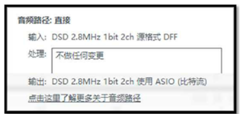
硬解后,DSD音频输入和解码输出采样数据相同
