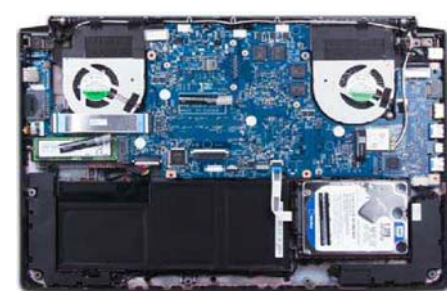
592G 是本次参测产品中唯一从 C 面拆解的,这意味着添加内存都需要彻底拆机,把主板取下才能进行。打开 C 面后可对 M.2 SSD、无线网卡和 2.5 英寸硬盘进行维护,也能进行风扇 / 排风槽的清理
