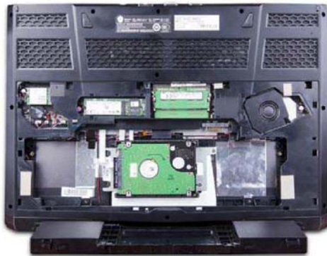
该机采用了底部小盖板方案,打开后可以方便地对内部进行基础维护,但需要注意的是机械硬盘位于电池下方,需要取下电池后方能维护。除此之外清灰工作也需要进一步拆下底盖(只用卸螺丝即可)
