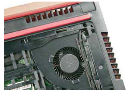
细心的读者朋友应该注意到了，Inspiron 15 7000 游匣版的一侧散热器采用了双出风口，因此整机有三个出风口
