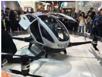
放大的载人版无人机亿航184,机身主体由四轴八架的动力系统、单人机舱和行李后备厢构成
