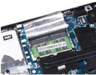
Y700 预留了 1 个 DDR4 内存插槽,且内存插槽有防电磁干扰的锡箔纸包裹,是本次参测产品中唯独使用这种设计的产品
