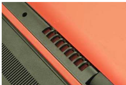
游匣15 7000的出风口开口很大,在打开屏幕后甚至可从上下两端同时出风,这个设计很是独特
