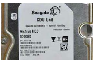
采用SMR技术的希捷8TB归档硬盘
