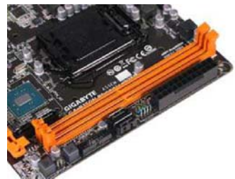
由于主板面积较小,所以只提供了2条DDR4内存插槽
