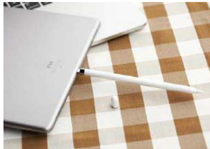
充电头隐藏在顶部,可以将它直接插在iPad Pro的接口上配对与充电,是很方便,不过笔帽太容易丢了
