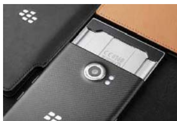
机身背部为主摄像头和双色温闪光灯,摄像头有点凸起。背盖采用了凯夫拉材质,具有一定的防刮防滑效果
