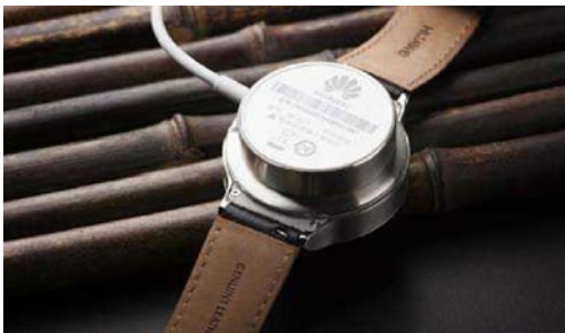
磁吸式的充电方式,充电时需要对准下方的金属触点
