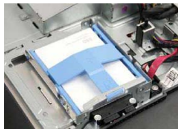
我们测试的版本搭载了 512GB 2.5 英寸 SATA 接口 SSD,除此之外还有一块 NVMe 接口的 256GB SSD,因此该机的响应速度非常快,而主流价位机型则以 HDD 为主
