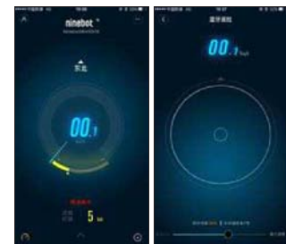
启用限速模式后，将只能以设定的速度行驶，自载人模式下，可以用手机遥控平衡车
