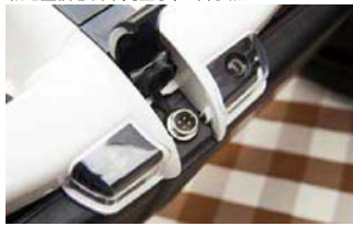
充电接口不但有防水罩进行保护，而且外部还有一块装饰盖，不会影响机身美观
