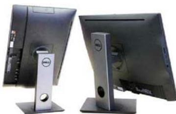
支架是商用一体机的一个特色设计,OptiPlex 24 7440 就有三种不同支架可选,我们拿到的机型除了可方便地进行 90° 旋转竖置之外也能轻松调节左右朝向,便利性十足
