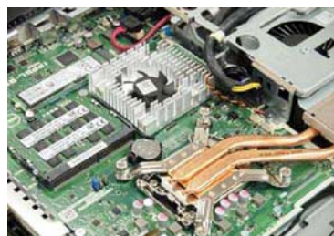
只需拧下一颗螺丝就能打开主板的屏蔽层,OptiPlex 24 7440 采用了桌面级处理器和移动版内存/硬盘的组合方案,综合易用性还是相当不错
