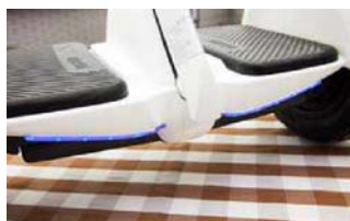
背部的LED灯组可以组合出N种闪烁方式，同时，刹车和转向时相应的灯组也会亮起
