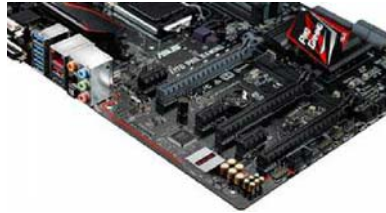
3条PCI-E × 16插槽和3条PCI-E × 1插槽是参测主板的标配
