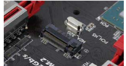
提供两个32Gbps速率的M.2接口,是技嘉GA-Z170X-Gaming 3的一大亮点
