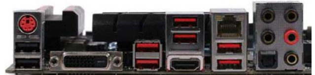
微星Z170A GAMING PRO虽然提供了6个USB 3.1 Type-A接口,但其仅为Gen1规格,速率为5Gbps,比USB 3.0快不了多少
