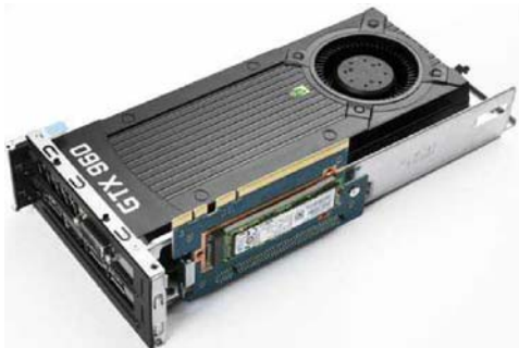
这就是拆下后的GTX 960显卡,可以看到底部加装了水平转接卡,同时还装载了一块NVMe 256GB SSD,虽然是共享PCI-E ×16接口,但基本上不会影响到性能
