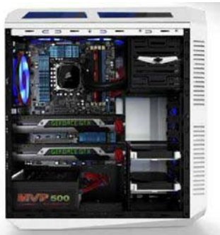
机箱内部良好的走线,是保证机箱内部散热的重要条件,同时也能将机箱打造得更加酷炫
