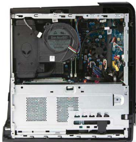
Alienware X51内部相当紧凑,但各种支架保证了配件的稳固性,下方的横条支架就是水平放置的显卡
