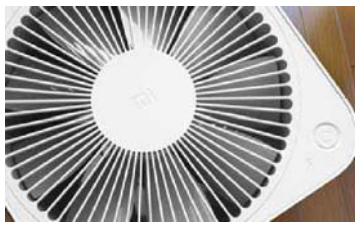
小米空气净化器 2 的风扇依然位于机身上方,隔离网经过了重新设计,不用担心家里小孩的手指伸进去
