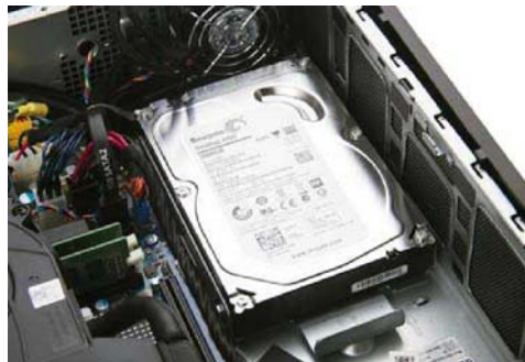
拆下显卡后,3.5英寸2TB硬盘安静地躺在其下方,配合机身前端的辅助散热风扇,机械硬盘也能稳定高效地运作
