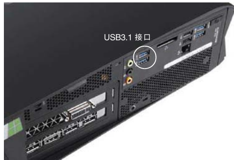
接口全面且完全跟上时代步伐,甚至还标配了2个USB 3.1标准接口,再加上显示扩展能力较强的GTX 960显卡,Alienware X51的功能性相当全面
