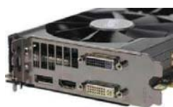
显卡提供了比较常见的2x DVI+HDMI+DP的输出接口组合,支持多屏输出
