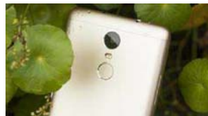
背部上方为1300万像素摄像头、双色温闪光灯和圆形指纹模块,四周都设计了金属切边
