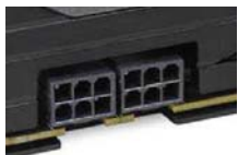
显卡的供电接口为双6pin接口
