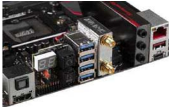
主板I/O接口除了常见的USB 3.1、USB3.0、HDMI等接口之外,还有清除CMOS按钮、USB BIOS Flashback按钮、开关按钮、重启按钮等,非常的丰富
