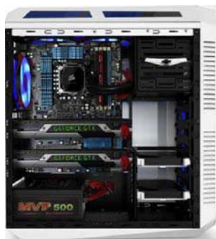
机箱内部良好的走线,是保证机箱内部散热的重要条件,同时也能将机箱打造得更加酷炫
