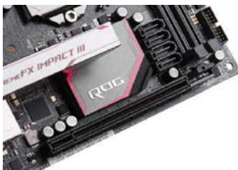
主板只提供了一条PCI-E×16插槽
