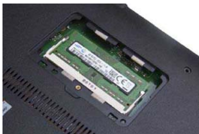
底部预留了一个内存盖板,要添加内存非常便捷。当然,要折腾硬盘和散热,就得把底盖整个打开了
