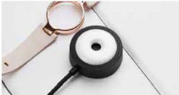
AMAZFIT手环采用无线充电技术,放在底座上就可以充电
