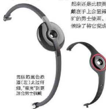
AMAZFIT手环采用无线充电技术,放在底座上就可以充电
