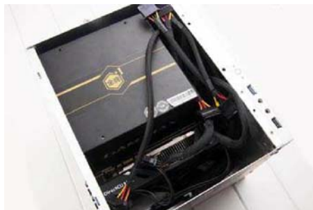
电源是固定在主板之上,平台完全安装之后,机箱内部空间非常的狭窄
