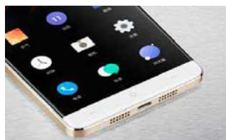
采用了和一加手机2相似的多任务、返回功能可切换虚拟按键,接口依然为普通的Micro USB
