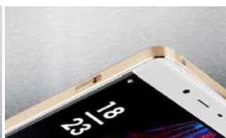
倍受好评的三段式开关得以保留,表面采用菱形纹处理,摩擦系数更大,拨动时手感舒适
