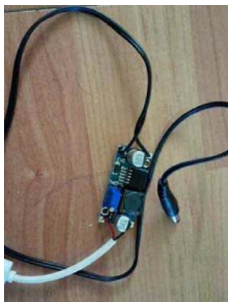
安装完成后的升压电路
