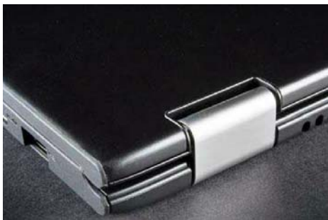
最初,360°后空翻变形本都采用了最简单粗暴的双转轴,设计难度和成本都相对较低,作为新市场的尝试而言比较适合
