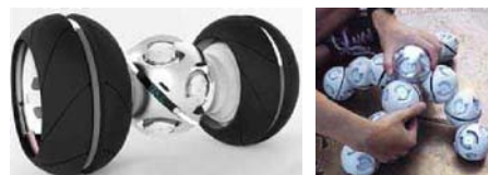
Xcell 部分就是专门为 Cell 机器人开发的,这是开发者搭建的一个可各种配件,图中是车轮单元和“心脏”单元的组合(科学怪人)
