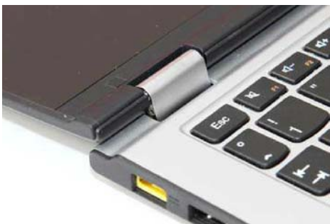
不过,双转轴的坏处一是笔记本无法做到轻薄,二是当屏幕180°开启时无法完全躺平,存在一定的遗憾
