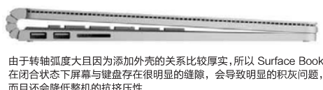
由于转轴弧度大且因为添加外壳的关系比较厚实,所以Surface Book在闭合状态下屏幕与键盘存在很明显的缝隙,会导致明显的积灰问题,而且还会降低整机的抗压性
