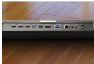
所有接口均位于主机后方,不用再每次伸到电视后面去费力插拔,HDMI 2.0、USB 3.0等主流接口一应俱全
