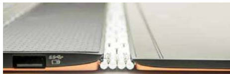
在联想Yoga 3 Pro上推出的表链式转轴堪称转轴视觉艺术的神来之笔,它解决了360°后空翻本难以做到轻薄的关键问题,而且任何开合角度都能提供合适的阻尼
