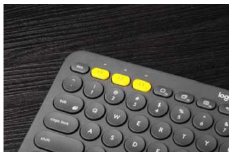
按下F1至F3三个键,就可以快速地在3个已配对的设备之间切换
