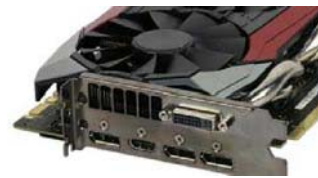
显卡的输出接口是3×DP接口、1×HDMI、1×DVI的组合
