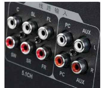
这类有5.1输入接口的就可以直接连接解码器
