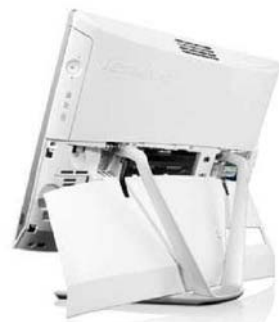
C360的可维护性也不错,下半部分后盖可以打开而对内存、硬盘、无线网卡等设备进行维护
