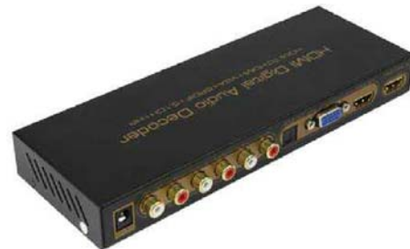
HDMI接口+光纤接口输入,模拟5.1输出,这类解码器也就四百元左右
