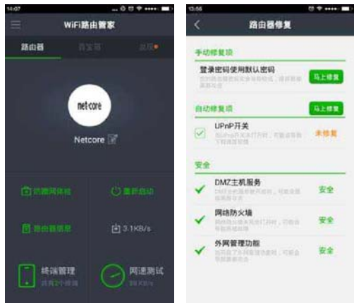
登录无线路由器后台成功后,APP 界面上的功能都能使用 APP 提供的路由器修复功能
