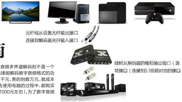
解码器+5.1有源音箱数字解码示意图
