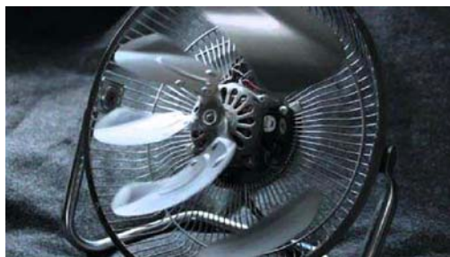
在拍摄高速移动的物体,比如转动的风扇叶片时,逐行扫描曝光的幕帘快门就可能让像素曝光时差从照片上体现出来,出现诡异的拍摄图片,而电子快门则不会出现这个问题
