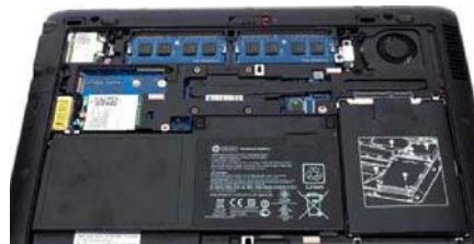
相对而言,EliteBook 820 G2则采用了免工具开底盖的设计,而且内部采用了大量防震滚架设计,同样也支持M.2接口SSD升级,且标配3年售后
