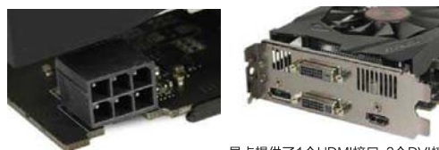
显卡采用单6pin接口供电
