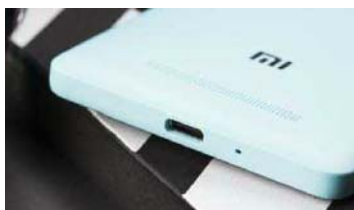
Type-C仍然是USB 2.0规格而非3.0,不过也是这个价位首家配备Type-C接口的了
