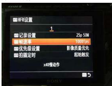
RX100 IV的超高速摄影支持多种拍摄模式,设置起来很简单,当以1000fps/960fps超高速拍摄时,可获得40倍减速的效果
