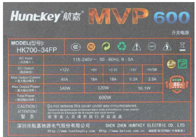
MVP600的+12V输出高达45A,专门针对高端显卡设计
