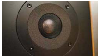
1英寸的钛膜球顶高音单元,动态明显提升
