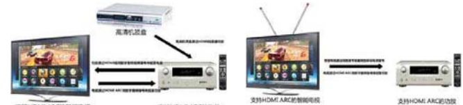
HDMI ARC的应用图示一:电视本地播放高清片源,可通过原有的HDMI线直接反向将数字音频输出到功放上解码
