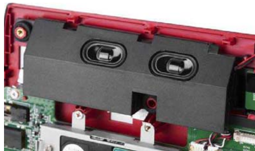
GE72 配备了 2.1 声道扬声器系统,每个高音单元都采用了双喇叭方案,再加上体积较大的低音单元和丹拿音效软件,听音效果较为出色
