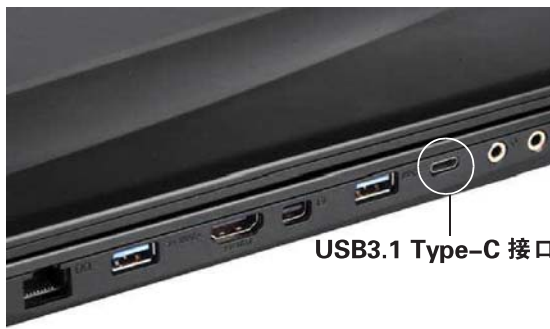
搭载 Skylake 处理器让 GE72 拥有了最新的接口设计,其中就包括 USB3.1 Type-C,虽然目前没有可以与之直接连接的设备,但已经可以买到转换器,增加笔记本的接口数量
