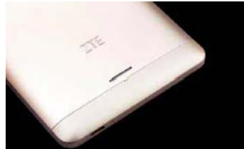
背部上下两端的天线区域被塑料材质包裹,与金属后盖色差很小,不影响机身的一致性
