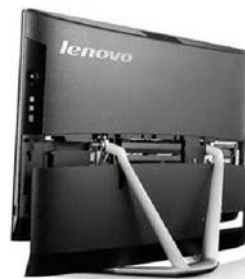
在可维护性设计上,C5030配备有升级硬盘内存的小盖板,而且还有联想拯救系统方便备份和恢复系统,比较人性化
