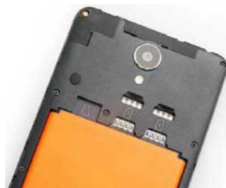
双4G卡槽、TF卡扩展、可更换电池,拆开后背,红米Note 2也展示了它实用的一面
