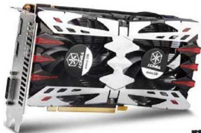
本次测试用的是映众 GTX950冰龙版,这是一款非公版显卡,默认频率 1178MHz,Boost 频率 1297MHz,显存频率为6800MHz
