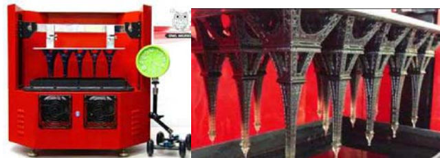
一次性构建 15 个 13cm 高的埃菲尔铁塔耗时不到四个半小时
