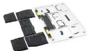
新MacBook的电池采用层叠式设计,目的就是与外壳紧密贴合,尽可能利用内部空间并提升电池容量,这种追求极致的细节设计值得学习
