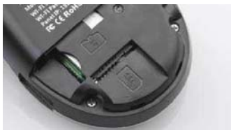
背壳轻松滑下,可看到 SIM 卡插槽,它需要使用大卡
