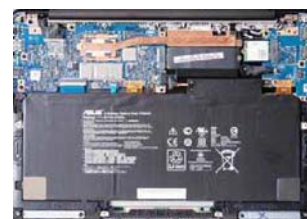
U305F则采用了维护非常方便的传统设计,底部盖板可直接打开。该机的内部结构非常紧凑,45Wh电池就占据了2/3的内部空间,主板面积小巧
