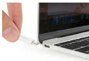
最厚仅13.1mm也就意味着机身接口的妥协,新MacBook机身除了音频输出之外,就只有一个USB Type-C接口,供电、数据交换、视频输出、连接扩展HUB全靠它,使用起来略麻烦,无法当作工作首选机使用
