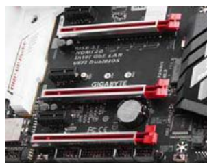
技嘉Z170X-Gaming7提供了3条PCI-E插槽,支持多卡交叉。同时所有PCI-E插槽上覆盖有金属防护罩,增加PCI-E插槽强度
