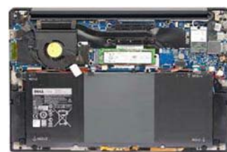
52Wh大容量电池是XPS 13超长续航的基础,而Broadwell微架构Core i5 5200U的低功耗特性更是将续航能力发挥到极致,联网办公可坚持11小时
