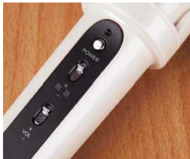
YaYa K歌麦克风3个按键分别是电源键、音量和混响控制
