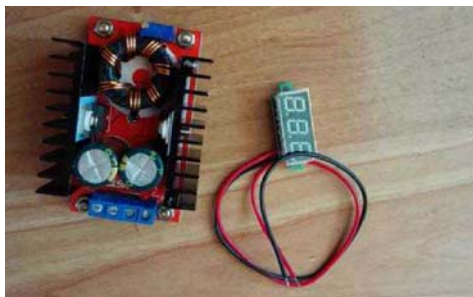
DC升压板和数显电压表
