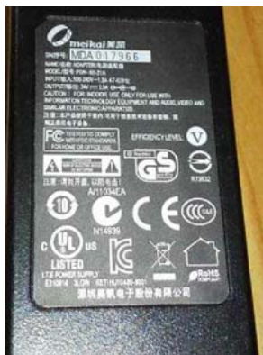
HKC T7000的电源适配器,显示的输出电流为24V/2.5A
