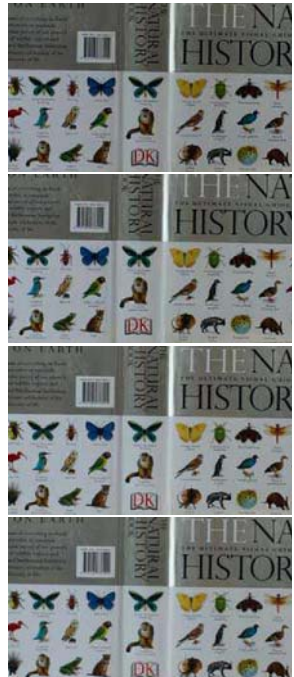
从上到下分别为 5DS R 的 F/5.6、F/10、F/14、F/22，可以看到从 F/10 开始出现锐度细微降低，到 F/14 变得很明显，F/22 已经不具备实用性，所以 5DS R 的极限衍射光圈为 F/10 左右
