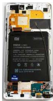
Note采用的是非异型主板,内部结构非常工整,不会挤占电池空间
