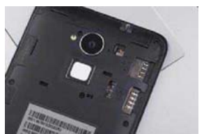
可拆卸后盖并不影响指纹识别模块,拆开后可看到它支持双卡,同时卡槽 2 上方还有一个 TF 卡槽
