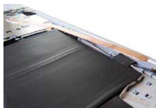
优雅 XS 采用了无风扇设计,但不知是否因为评测机的关系,内部热管居然没有固定,打开后就这样“腾飞”于半空中,让人感觉相当诡异……
