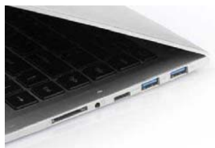
虽然机身厚度仅为 16mm,但优雅 XS 依然配备了 2 个 USB3.0 接口,可满足绝大多数情况下的日常使用需求
