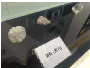
萤石的颜色有很多,但用于高端镜头镜片的,一定会采用无色透明的纯净原石
