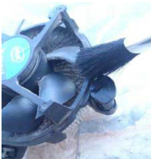
打扫处理器风扇与散热器
