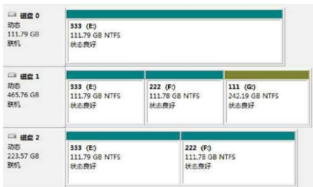
3 块不同容量的固态硬盘可同时组建不同卷,充分利用空间
