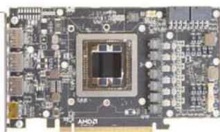
Fury X的PCB板,少了大面积分布的显存颗粒,更加的紧凑
