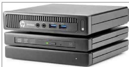
为了弥补微型小巧带来的扩展性不足,ProDesk 400 G1 DM迷你商用台式机支持多功能模块化扩展方案,惠普推出了多种模块可用,即便都装上也不会让整机变得臃肿
