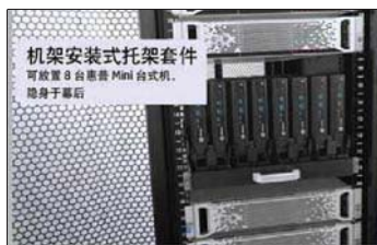
为了方便管理,惠普还为ProDesk 400 G1 DM迷你商用台式机推出了机架安装式托架套件,非常适合企业用户选择
