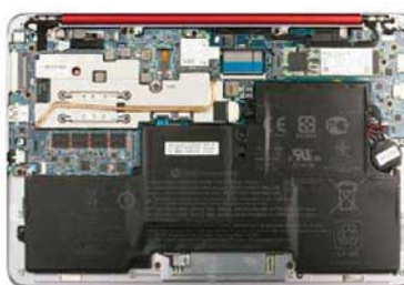
虽采用了无风扇设计,但满载时内部温度也不会很高。低功耗处理器即仅仅配备 36Wh 容量电池,续航能力也轻松突破 7 小时
