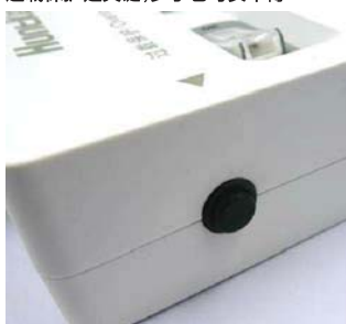
航嘉SSH801带有过载保护功能,在排除过载之后按下按钮可恢复工作
