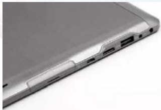
机身左侧带有标准 USB 接口,可以直接连接键鼠或闪存
