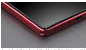
左下角的挂绳孔,上方扩展卡槽有些翘起,做得不够平整
