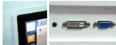
白色边框仅2mm DVI和VGA接口比较适合老平台升级
